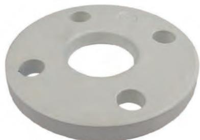
Le flange piane libere (scorrevoli) in alluminio utilizzate in vari settori dell'industria, vengono infilate sul tubo e fanno battuta contro un anello-collare (cartella) in acciaio saldato al tubo.
