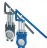
Valvole monoblocco unidirezionali, tipo Wafer con comando sia manuale che pneumatico/motorizzato. Corpo in GHISA verniciato epossidico / AISI 304 / AISI 316. PARATOIA (LAMA) AISI 304 / AISI 316L. Foratura flange EN PN10.
