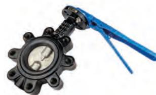
Valvola a farfalla tipo Wafer PN 16. Corpo in Ghisa + vernice epossidica, guarnizione in EPDM, Lente Inox.
